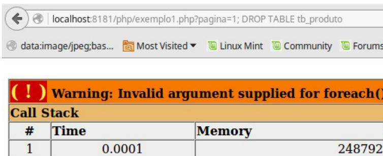
Figura 11.22: Erro após executar o SQL injection
