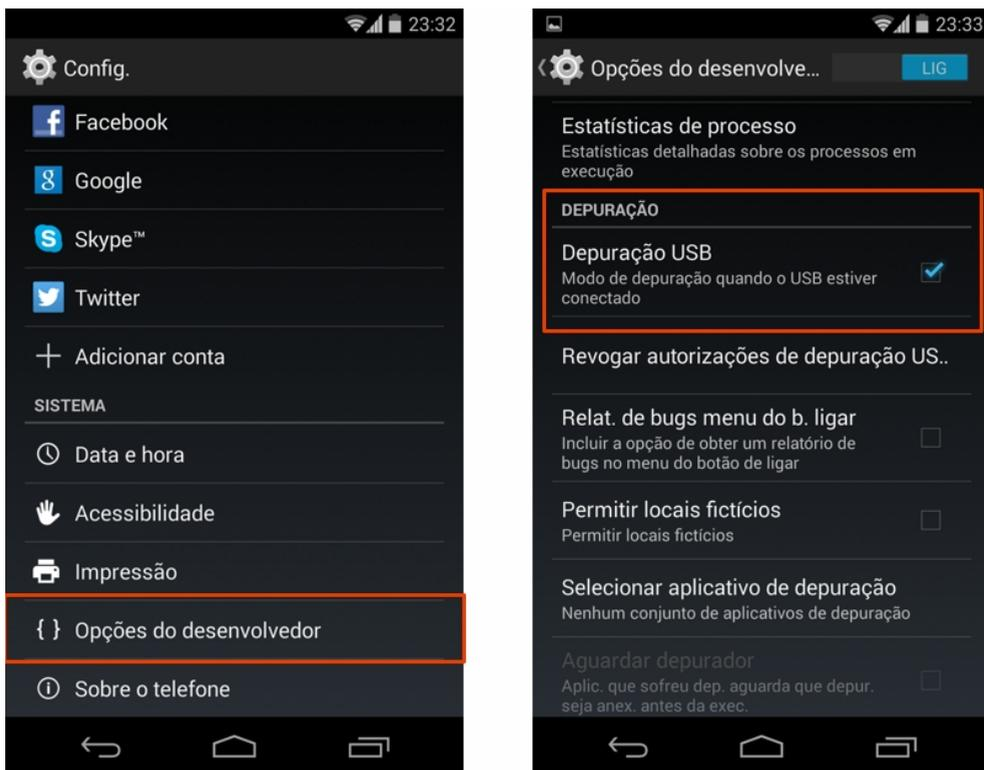
Figura 10.28: Configuração da depuração USB no Android
